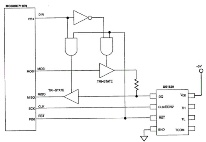
Figure 1. SPI to DS1620 Interface Circuit
